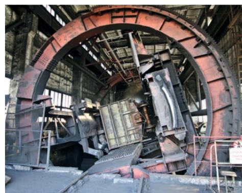
Вагоноопрокидыватель для разгрузки угля
