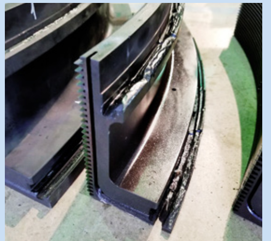
Забракованные в ходе дефектации сегменты кольца направляющего аппарата 4-й ступени
